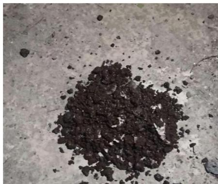
图 3 混合料散落图
