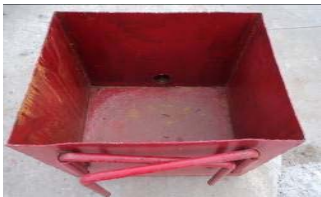
图1 吊挂式油水回收池
