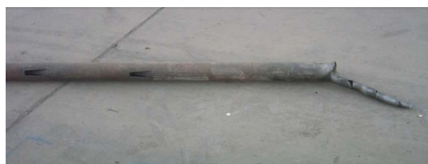
图4 使用套铣筒+母锥套捞组合式工具打捞出油管及油管残体
