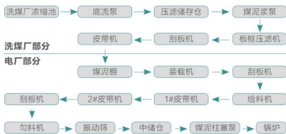
图1 典型煤泥处理工艺系统流程图
