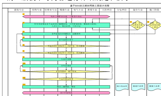
图1 BIM 正向设计总流程示意图
