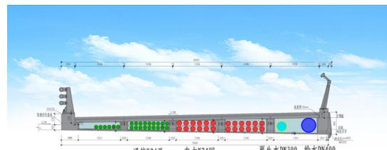
图8 桥梁段管廊敷设示意图(二)
