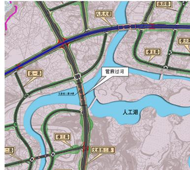
图6 管廊过河平面示意图
