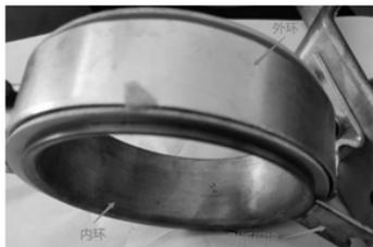
图7 新结构灭弧装置
