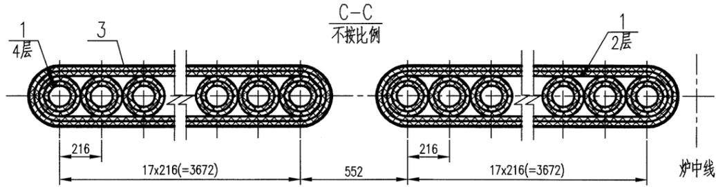
图2 炉纤维毯包裹示意
