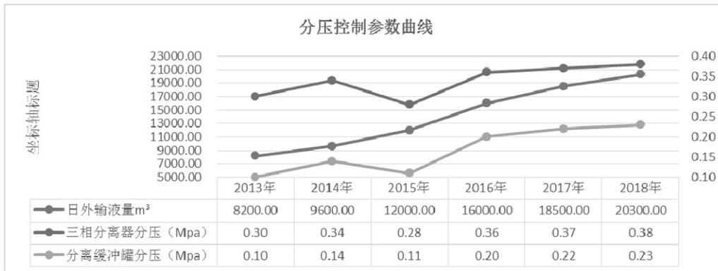
图6 不同井组来液量时压力控制参数曲线变化图
