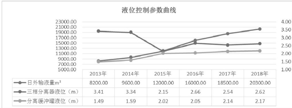
图5 不同井组来液量时液位控制参数曲线变化图
