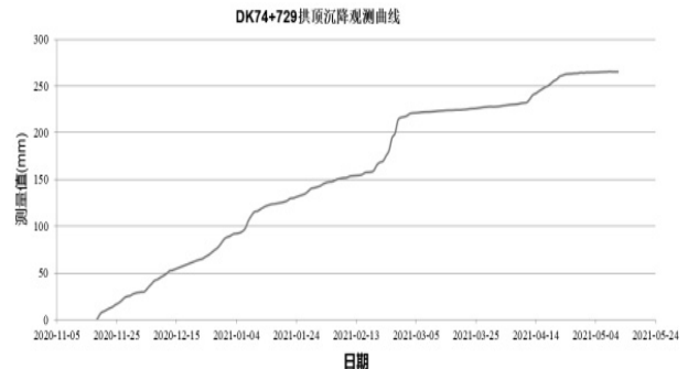
图8 洞口拱顶沉降曲线
