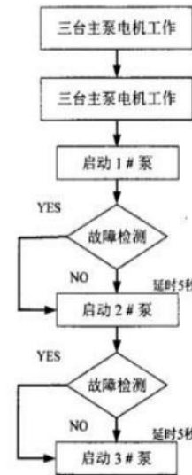
图 3 三台水泵电机开启流程
