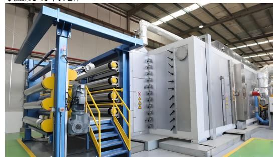
图3 均匀温度场氧化炉
