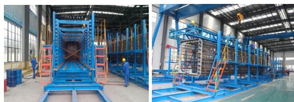
a. 主筋安装（一）
