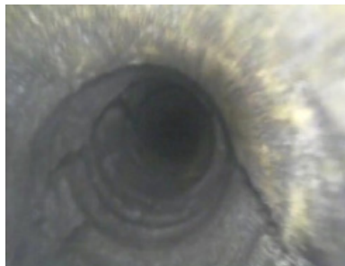
(a) 中细砂岩，对称裂隙
