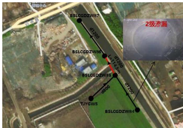
图2 15号过河管管道缺陷点位示意图
