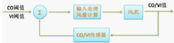
图 1 公路隧道通风反馈控制
