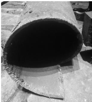
2月19日, 下 $\Phi 244.5\text{mm}$ 套铣头+内扶正+ $\Phi 193.7\text{mm}$ 套铣管13根, H: 141.47m (套管鱼顶 138.00m)。
