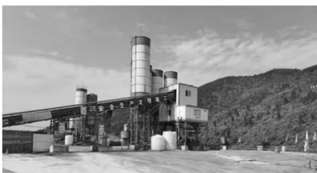
图2 大型混凝土搅拌系统
