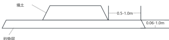
图 2 砂垫层堆载预压断面图
