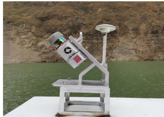
图 1 船载 LiDAR 系统
