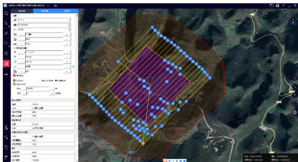
图4 应急航摄航线布设示意图
