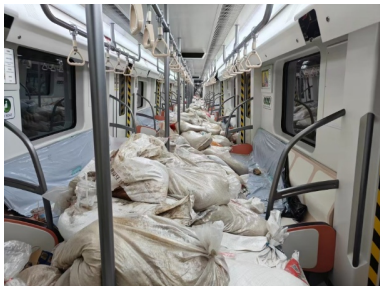
图2 试验列车内配重照片
