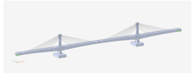
图3 本桥Midas/Civil有限元模型
