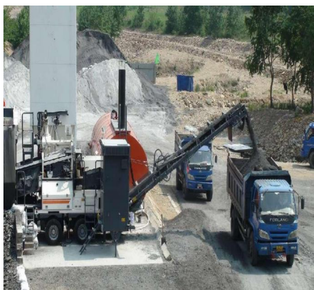
图 4、5 KMA220 型厂拌冷再生机组生产设备示意图
